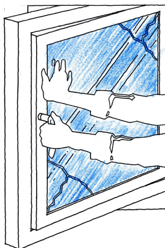
Figur 1. Skjuvning vid öppning/stängning av fönsterbåge
