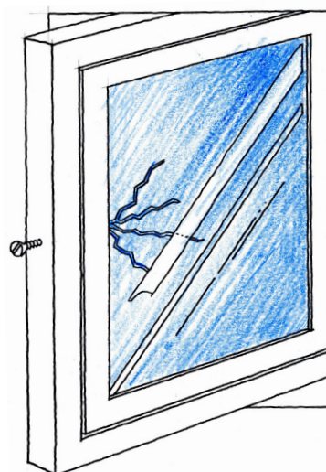
Figur 3. Kantskada efter yttre åverkan
